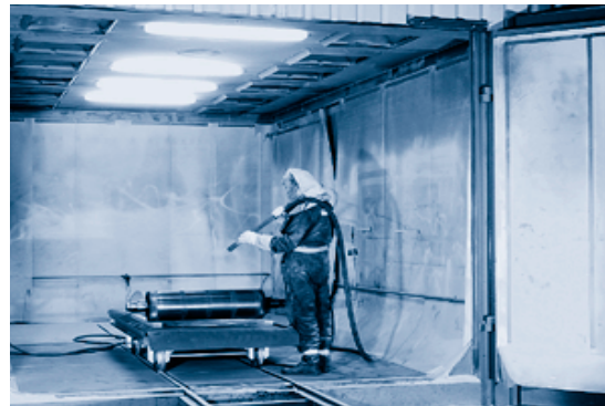
1 Strahlraum für Glasperlen 6 m (L) x 4 m (B) x 3 m (H)
