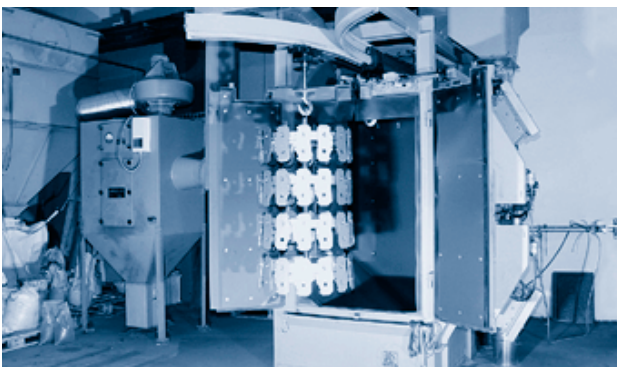
1 Schleuderrad-Hängebahn-Strahlanlage für Steelshot, Werkstückgrößen bis \varnothing 1,0 m x 1,3 m
