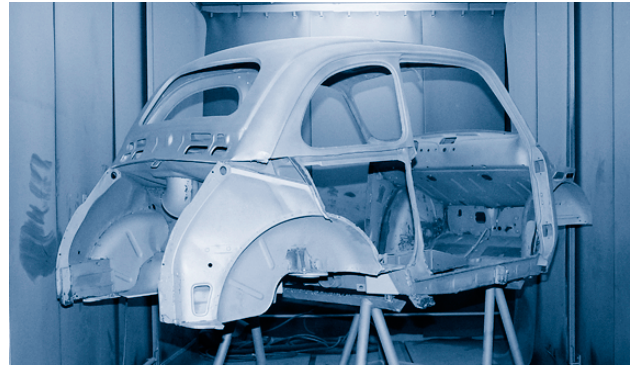
1 Strahlraum für Korund 5 m (L) x 3 m (B) x 3 m (H)
