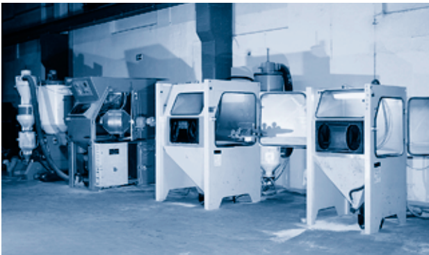
3 Druck- und Injektorstrahlkabinen mit Strahldüsen- und Werkstückbewegung, für alle Strahlmittel
